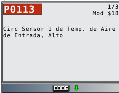
En este ejemplo, el módulo del motor informa un código previo. \$10 es la dirección del módulo del motor.
