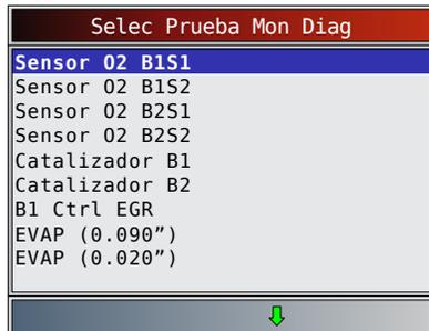
En los vehículos que no utilizan CAN la herramienta de escaneo muestra:
