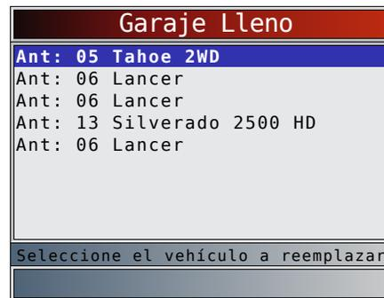
La selección OBDII/EOBD se proporciona para vehículos que no aparecen en la lista, sin embargo, la selección de un vehículo específico se recomienda para obtener el funcionamiento máximo de la herramienta. El vehículo seleccionado anteriormente aparecerá como la selección de menú **Ant:** después de **Asia**.
