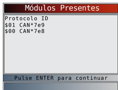
Dado que los vehículos que utilizan CAN emplean unas ID del módulo de más de 2 dígitos, la herramienta de escaneo le asigna una de 2 dígitos a fin de ser utilizada en lugar de la ID del módulo CAN actual. Esta ID de módulo asignada para el módulo CAN se utiliza en todas las funciones de la herramienta de escaneo.
