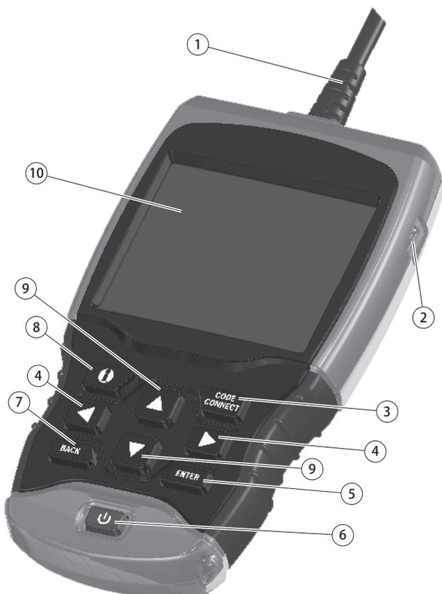
1. El cable del DLC proporciona la conexión para la interfaz del vehículo.
